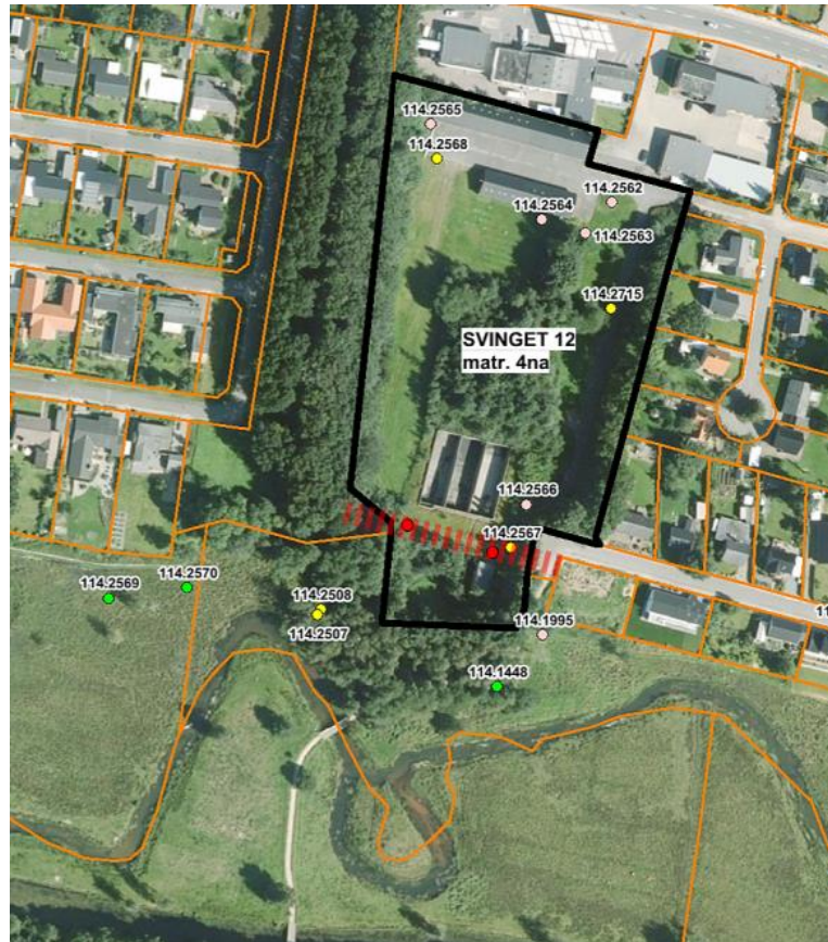
Figur 7-3 Indledende forslag til placering pumpeboringer og med angivelse af oplandsbredden, som vurderes at være 78-112 m ved 10 meter filtre.
